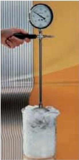
a) Termómetro de gas con volumen constante
